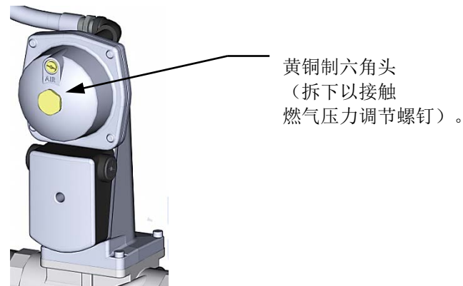
图 8-2: 带有燃气压力调整装置的 SSOV 驱动装置
